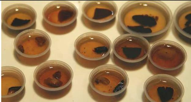
Moulage des blocs dans des capsules PVC (couvre-capsules de boîtes à médicaments) → difficile à démouler
