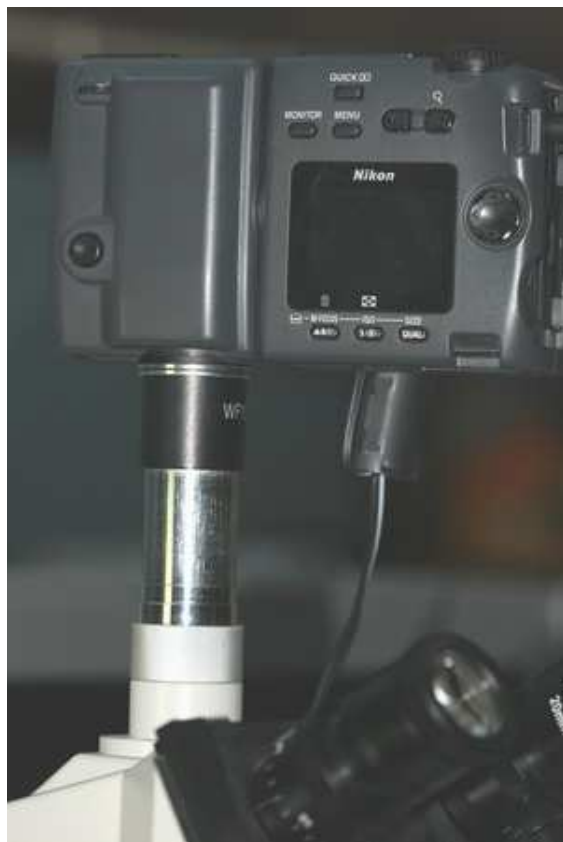
Un Coolpix 995 avec son oculaire photo fileté et un adaptateur posé sur un tube trino d'un Euromex (photo Marcel Lecomte)
